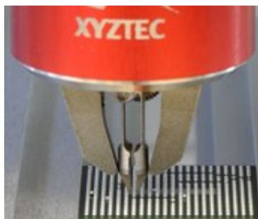
USB 电动夹爪执行锡球拉力 (CBP)
