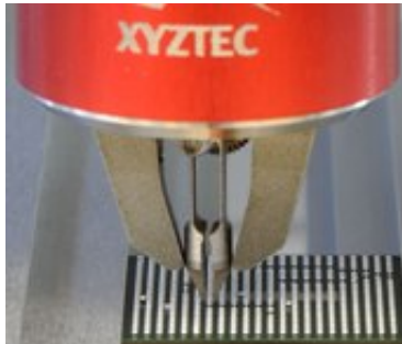
USB 電動夾爪執行錫球拉力 (CBP)
