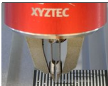
USB 電動夾爪執行錫球拉力測試(CBP)
